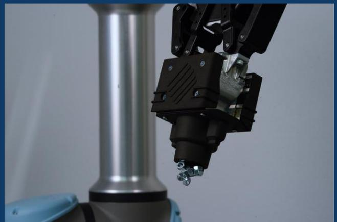
**ToolCubes** sind **roboterunabhängig** und können mit vielen herkömmlichen 2-Finger-Greifern verwendet werden, egal ob Industrieroboter oder Cobot.
