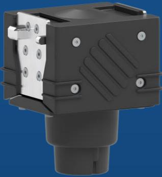
Mit dem MagnetGripper können ferromagnetische Teile gegriffen werden. Das Maximalgewicht eines flachen Bauteils, das mit dem MagnetGripper gegriffen werden kann, beträgt 300 g. Es wird empfohlen, die beabsichtigte Handhabung des Bauteils mehrmals zu testen, da die Legierung, die Oberflächenbeschaffenheit und -form des Bauteils ausschlaggebend für das Maximalgewicht sind.
